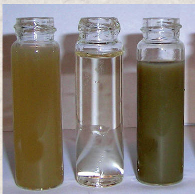
Vann filtrert gjennom jord med delvis plantedekke, fullt plantedekke eller uten plantedekke. Jord med fullt plantedekke renser vann effektivt. Foto: Rut Skjevdal, NIBIO
