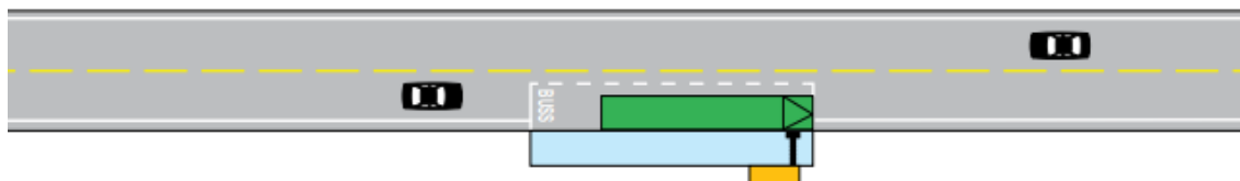
Figur 23: Prinsippløsning for kantstopp. Plattform i lyseblått, lehus i oransje, taktile heller vist med sort strek.
